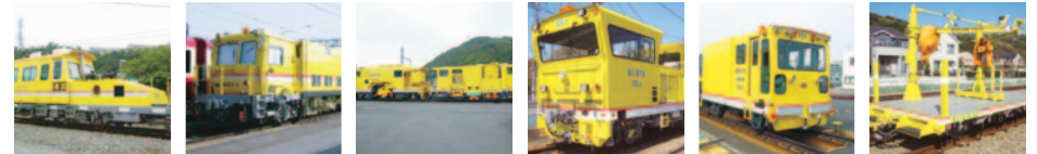
軌道検測車「EM30」 軌間、水準、高低、通り、平面性を検測します。
